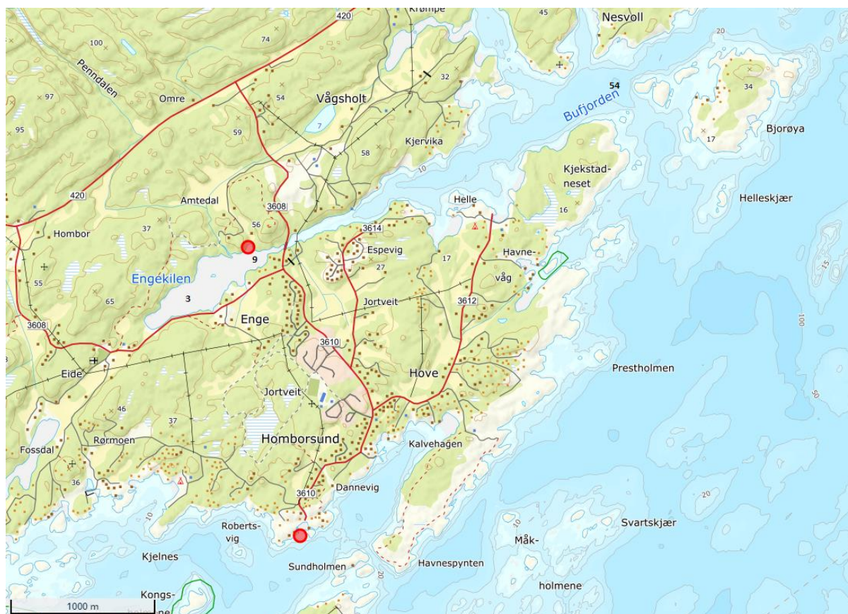
Figur 1: Området rundt Engekilen. Bunntopografien i kilen vises som en et grått felt på kartet, siden den ikke var oppmålt før dette prosjektet. De røde punktene viser hvor det i dette prosjektet har blitt tatt vannprøver i overflatelaget fra mars til november. Kart er hentet fra kystinfo.no. Torungen fyr som omtales i dette notatet ligger 22 km nord-øst for Engekilen.
